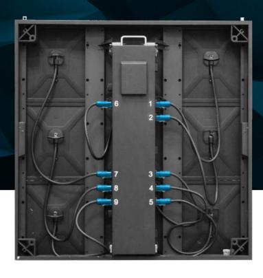
Le **DIAMOND** est conçu pour être un affichage LED fixe extérieur économique. Ses éléments faciles d'utilisation facilitent la maintenance et favorisent une intégration rapide. Les câbles intégrés, les modules et le bloc d'alimentation indépendants facilitent grandement l'installation du **DIAMOND**.
