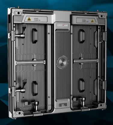
Le **SILICIUM** est la toute dernière addition à notre gamme d'écrans LED accessibles par l'avant. Destiné aux applications en extérieur, ce produit de haute qualité offre un pixel pitch fin ainsi qu'une excellente résistance aux intempéries. Son affichage lumineux en fait un caisson LED idéal pour les affichages publicitaires car il permet une excellente visibilité par tous les temps, de jour comme de nuit.
